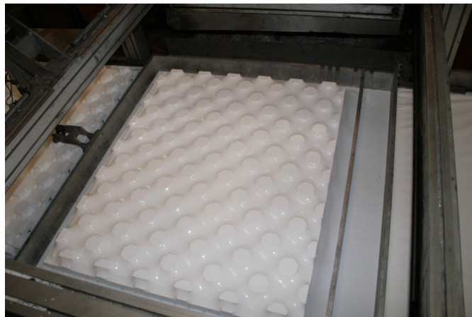
Le film prend la forme de la plaque lors de l'aspiration sous vide
