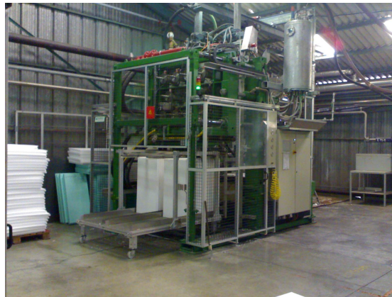
Moulage de plaques d'isolation murale
