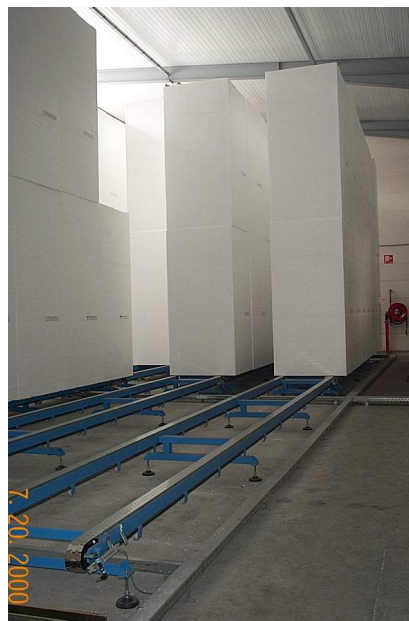
Le stockage des blocs sur tapis roulants
